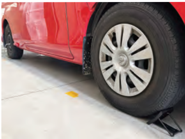
ジャッキアップの準備
