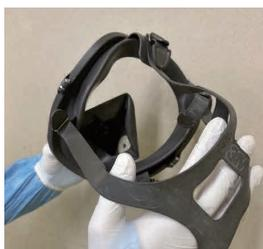
面体及びしめひもの破損確認
