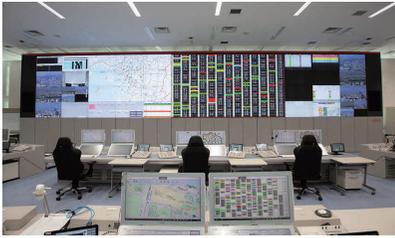
55インチ液晶画面を縦4面×横12面に接続し設置したもので、高所監視カメラ映像やヘリコプターテレビ電送システム映像をはじめ、各種災害支援情報を表示することで情報共有を図るとともに、消防活動の支援を行うことができます。車両表示板には、約400台の消防・救急車両の動態情報10項目を色で識別し、消防隊等の活動状況を常時把握することができます。
