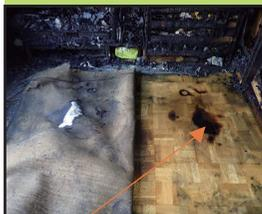
※残渣を掘り起こして床をめくると次第に焼きの強い箇所が見えてくる。
