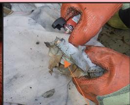
※素材が不明な場合は着火させて**燃烧実験**をする。
