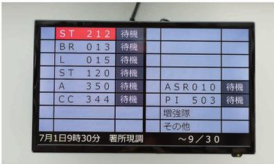
消防指令センターからの出場指令情報により、表示型受令装置（液晶ディスプレイ）に各隊別の出場指令を表示します。
