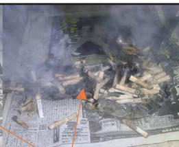
※実験ではガラス製灰皿に山盛りの吸殻が燻焼し、白煙を上げ炎を上げることなく**無炎燃烧**を続け、**約20分後**にガラス製灰皿が**割れた**。
