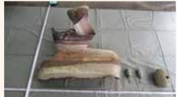
写真1：破裂したボンベ
