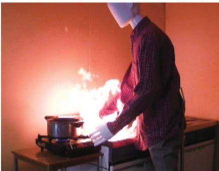
調理中の火が、シンク内に滞留したカセットこんろ用のガスボンベのガスに引火した映像
