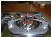
過熱防止装置(設定温度(250℃)以上になると自動的にガスを遮断する)
