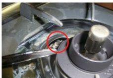
立ち消え安全装置(こんろバーナーの火が何らかの原因で立ち消えた場合、熱電対が冷やされ、電磁弁が閉じてガスの流出を防ぐ)
