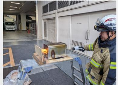
スプレー放水（ドライヤーで再現）は強い気流が発生。その影響を本実験で確認できます。
