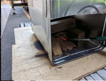
一斗缶内に木材、スポンジを設置し、着火。燃焼時間、燃焼物による煙の量、色の違いを観察。
