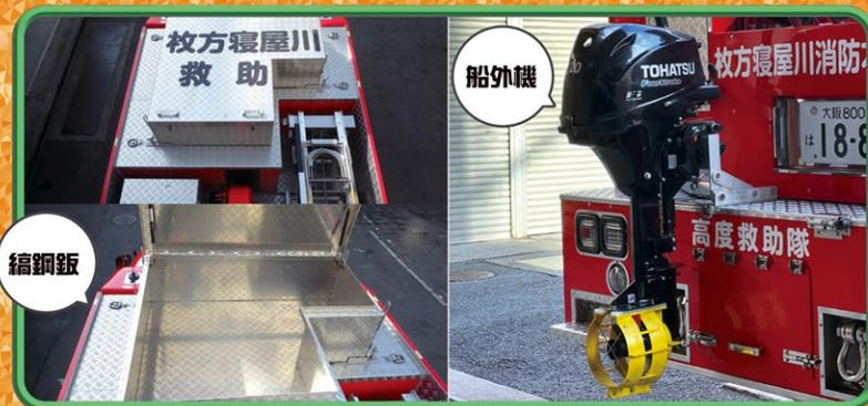
消防車両用語 ④ 編鋼板：表面に滑り止めの突起が付いた鋼板
