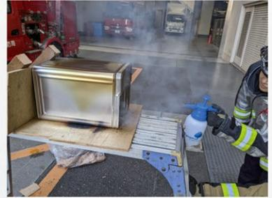
背面の開口部（窓）の有無、放水形状（ストレート、スプレー）による吹き返しの違いをチェック。
