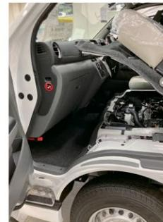
エンジンメンテナンス時には写真のようにシートを上げて固定する必要がある。
