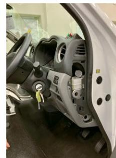
運転席ハンドル横に設置されたブレーキリザーバータンク。(カバーを外した状態)
