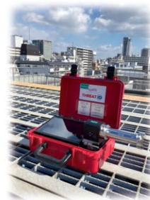
気体の化学物質を検知測定するための資器材。本体にステンレス製のガスセルというものを取り付けてその中に気体を送り込み識別を行う。Android 搭載の物質識別装置。淀川 CR が保有。
