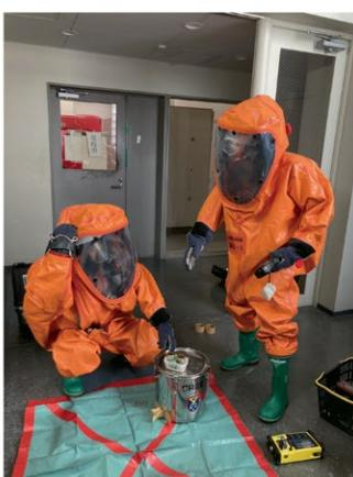
剤が散布されている場所でサンプリングを行い、CR 保有検知資器材で剤を分析・検知する。また、原因物質が撒かれている災害箇所の情報収集を行い、分析・検知結果とあわせて指揮本部へ伝える。写真のようにビニールシートを敷くことで原因物質の揮発を防ぐのと同時に活動隊員の靴底に付着した原因物質が無意識に拡散される場合があるため、不用意に近づかないよう原因物質の場所を周知する目的もある。
