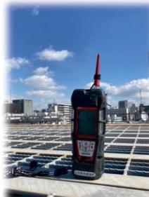
酸素・硫化水素・可燃性ガス・一酸化炭素の他に塩素・アンモニアの検知が可能。東成 CR と淀川 CR が保有。
