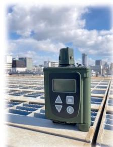
気体の化学剤を検知することができる空間検知資器材。液晶ディスプレイに表示される識別コードにより剤の種類を知らせる。全 CR が保有。
