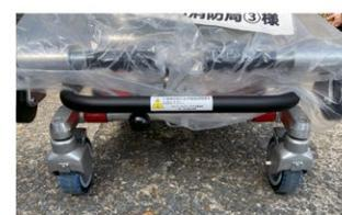
ストレッチャーについては最新型の導入により、車輪が接地時に横に曲がらなくなった。この仕様により、ストレッチャーベッドを低い位置のまま移動させることが容易になっている。
