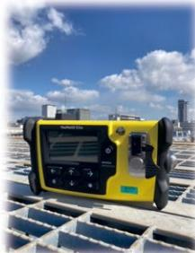
液体と固体の化学物質の検知が可能。液晶画面横のセンサーに剤を置いて分析する他、本体の側面のセンサーに直接剤を触れて剤を特定することもできる。東成 CR と淀川 CR が保有。
