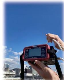
高濃度の硫化水素を検知可能。酸素と可燃性ガスの検知も可能。全 CR が保有。
