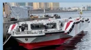
バラスト装置及び操舵室屋根昇降装置降下状態
