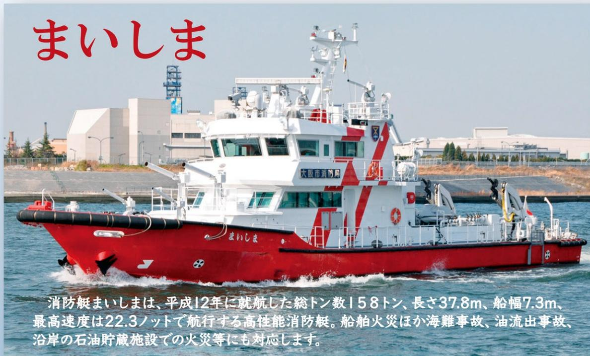
消防艇まいしまは、平成12年に就航した総トン数158トン、長さ37.8m、船幅7.3m、最高速度は22.3ノットで航行する高性能消防艇。船舶火災ほか海難事故、油流出事故、沿岸の石油貯蔵施設での火災等にも対応します。
