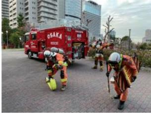
ホースカーの最上段はGN (eノズルホルダー装着)、40mmホース×1、65mmホース×1、定流量器が積載されています。南阪町Rが消火任務で出場する可能性があるのは他署管内であり、南阪町R182はタンクが無い車両なので消火栓部署又は他隊との相掛りとなります。そのため、放水時の他隊の停車時の反動力、路上放水等高压力で放水、梯上放水等の不安定な姿勢での放水、隊員の習熟度を考慮し、GNにはeノズルホルダーを常時装着しています。
