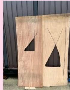
玄関扉を木材で作成し、実際に切断できるようにしました。切断後を写真で記録することにより各隊への具体的な指導やアドバイスが可能になりました。
