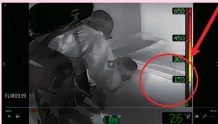
2階の床下に熱した木炭を入れた一斗缶を熱源として配置しました。1階から上階に熱が推移する様子を再現し、各隊は熱画像で実際に熱を確認することで、より実現場に近しい訓練が可能になりました。
