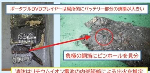
消防はリチウムイオン電池の内部短絡による出火を推定
