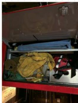
車内は救助資器材が多くあるためホースバッグは隊員席には積載していません。また、早期の1線2口放水も考慮し、GNをホースカーのサイドに積載しており、ホースについてはホースカー上部のハッチに40mmホース×1、65mmホース×1を積載し、現場到着後にホースカー上部に乗せます。ホースの収容方法は、ホース延長場所が広い場合、狭い場合どちらにも対応できるように、蛇腹でホースを収容しています。
