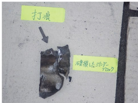
破損したシリンダーブロック
